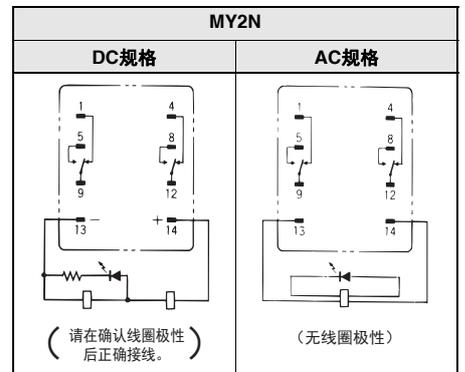
注1: AC规格备有线圈断线自检功能。
