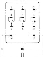
(请在确认线圈极性后正确接线。)
