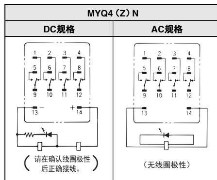
注1: AC规格备有线圈断线自诊断功能。
