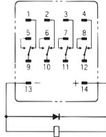
(请在确认线圈极性后正确接线。)
