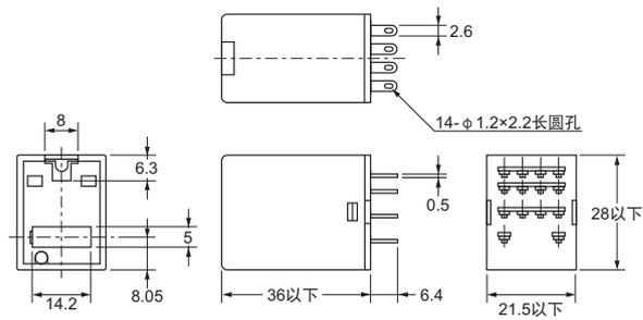
端子配置/内部连接图 (底视图)
