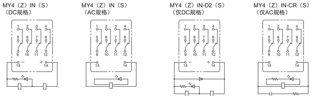
注: 对于DC规格, 请在确认线圈极性后正确接线。
