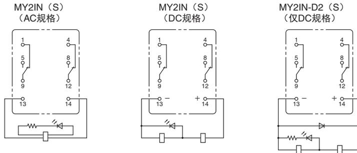
注: 对于DC规格, 请在确认线圈极性后正确接线。
