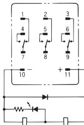
(请在确认线圈极性后正确接线。)
